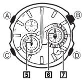
5. 確認 [5] 左下子盤針的基準位置正確後，按 (C) 鈕。此時手錶進入 [7] 日期調整狀態。
