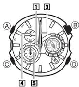
4. 確認 [1] 時針及 [3] 分針的基準位置正確後，按 (C) 鈕。此時手錶進入 [6] 右子盤針的基準位置調整狀態。
