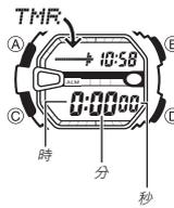
倒數計時器可於 1 分鐘至 24 小時的範圍內進行設定。當倒數到達零時，鬧鈴會鳴響。本倒數計時器還備有自動重複功能及可通知倒數進度的進度響報。
