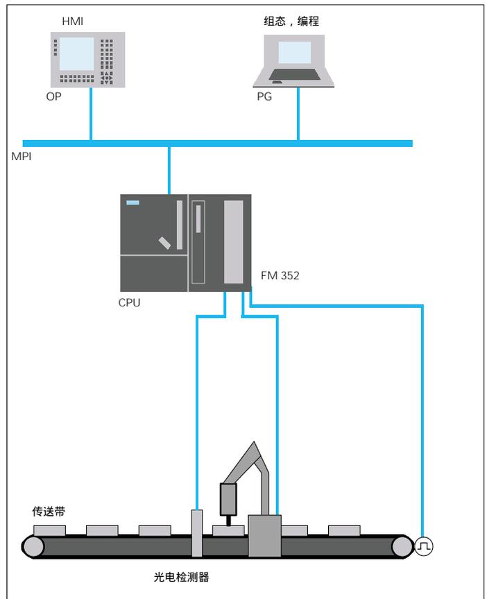
图 1-18 使用 FM 352 进行控制器调整
