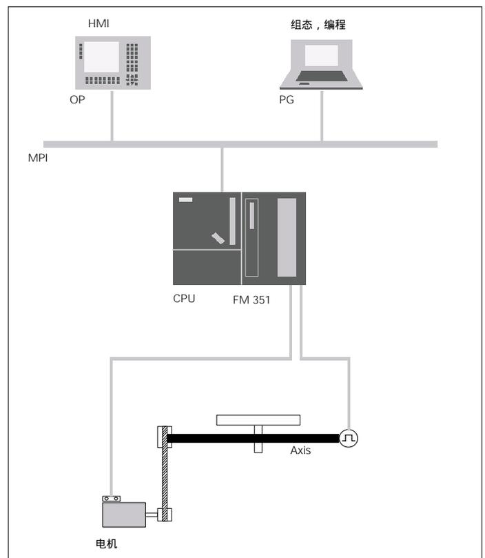
图 1-17 用 FM 351 实现定位控制
