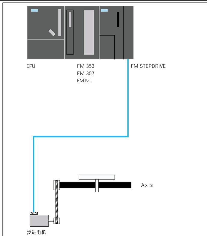
图 1-23 采用 FM STEPDRIVE 的定位任务结构
