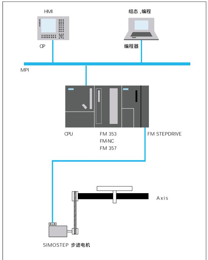
图 1-25 采用 SIMOSTEP 步进电机的定位装置
