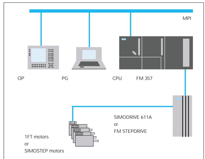
图 1-21 采用 FM 357 的定位任务结构
