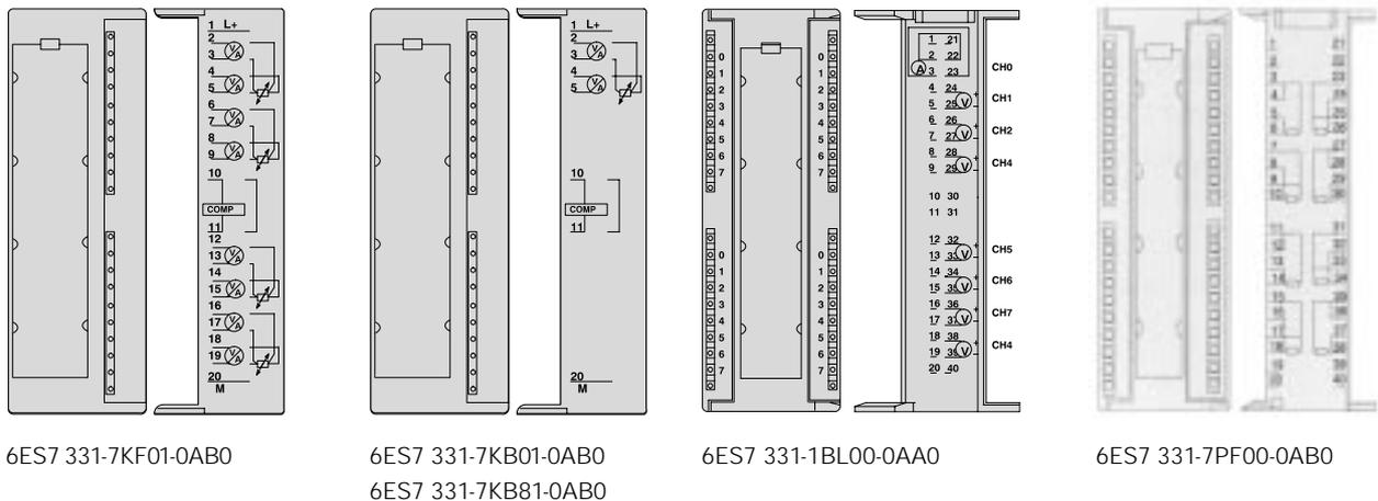
图 1-10 SM 331 模拟输入模块端子接线图
