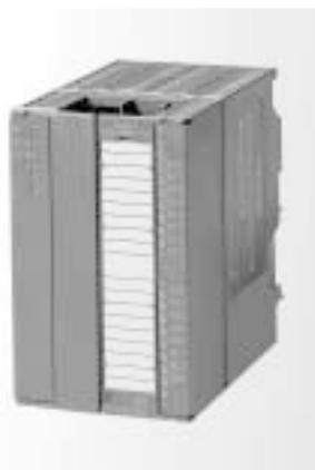
SIWAREX M 是将其称重功能全部集成于 SIMATIC 自动化系统的有校验能力的电子称重和配料单元。SIWAREX M 集成在 SIMATIC 中，作为一个自由编程的称重系统，可以用它综合解决各种任务，组成多料称和多称系统。配料控制不依赖于自动化系统的周期时间，从而可以准确无误地关闭配料阀，达到最佳的配料精度。
