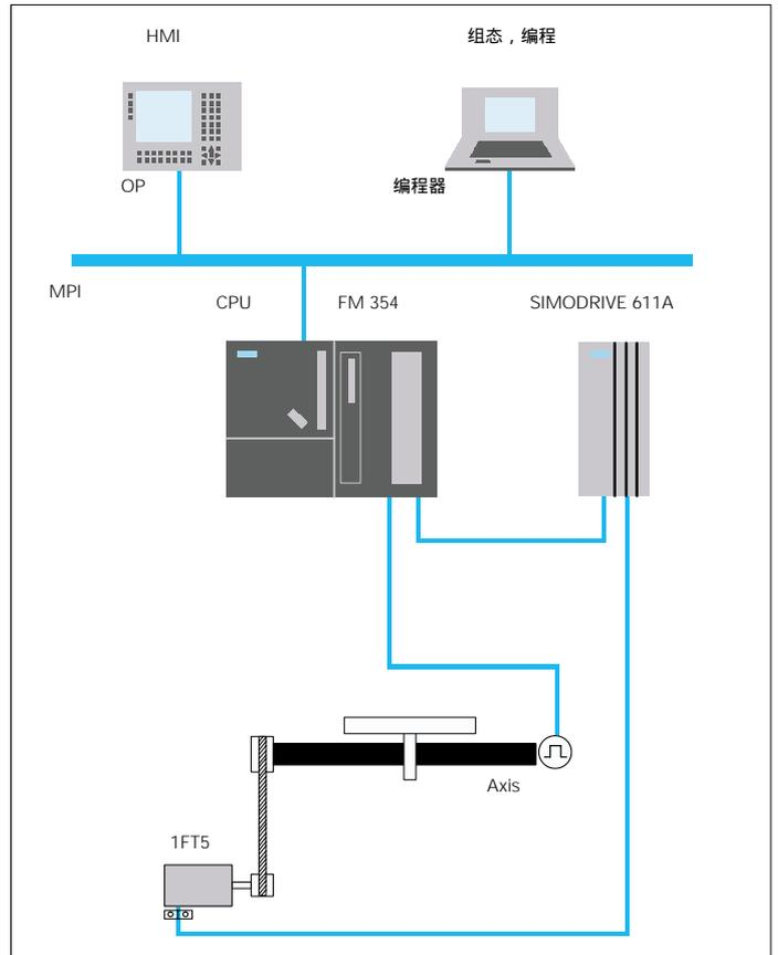
图 1-20 采用 FM 354 的定位任务配置
