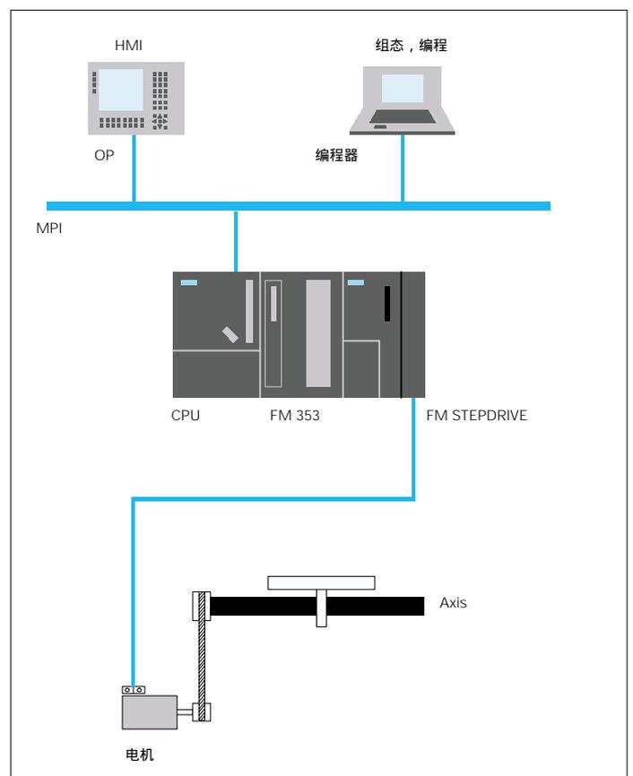
图 1-19 采用 FM 353 定位任务结构设计
