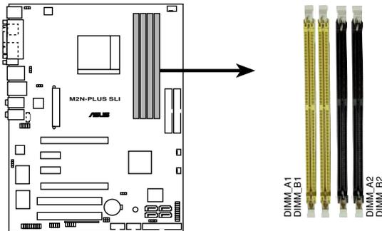
**M2N-PLUS SLI 240-pin DDR2 DIMM sockets**
