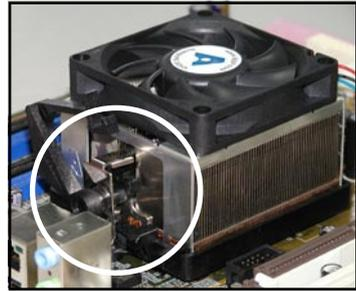
4. 最后再将支撑机构两侧上方的固定杆分别拉下锁住，使得风扇和散热片能紧密地扣住支撑机构底座。
