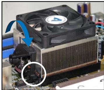
5. 当风扇、散热片以及支撑机构都已安装完毕，接着请将风扇的电源适配器插到主板上标示有「CPU\_FAN」的电源插槽。
