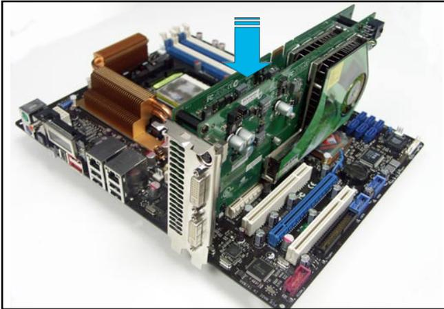
4. 接着将第二张 PCI Express™ 接口显卡安装到标示有 PCIEX16\_2 的第二组 PCI Express x16 接口插槽中。并确认显卡已紧密地安装至插槽中。
