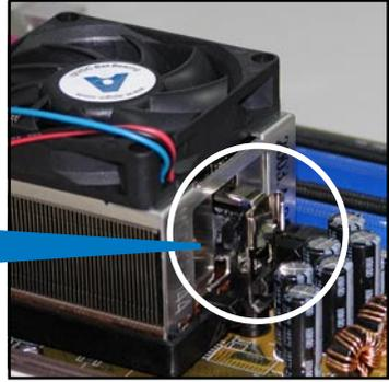
3. 再将另一边的固定拖架也扣在支撑底座上（靠近支撑底座固定把手），当固定拖架正确的扣住支撑机构底座时，会有一声清脆的机构组合声。
