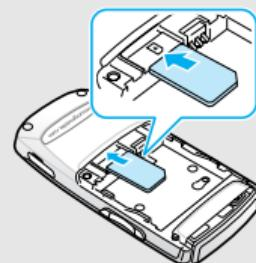
确保 SIM 卡金属触点面朝向手机。
