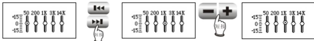
调节幅度时以3dB为步径，最大可调范围为±15dB，设置完后按 **M** 键确认退出，按 **■** 键不保存并退出。
