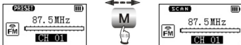
进入收音模式之后，短按 键可在PRESET（正常收听）和SCAN（搜台）模式之间切换。在PRESET模式下，短按 / 键选择频道，长按 / 键可全自动搜台；在SCAN模式下，短按 / 键可调整频率，长按 / 键可半自动搜台，
