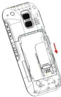
2. 取出 SIM 卡:将一只手指钩住 SIM 卡上的缺角处, 另一只手将 SIM 卡向上推。
