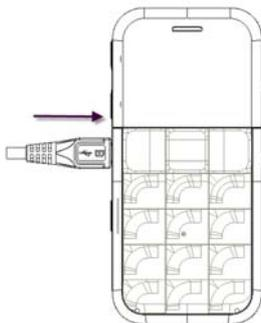
2. 充电结束后, 先将充电器从插座中拔出, 然后从手机上拔下充电器插头。
