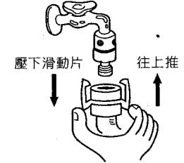
5 接上給水管後，打開水龍頭查看是否有漏水的現象。若固定螺絲未鎖緊或傾斜，就會漏水。
