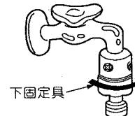
4 細水管插入固定具時，必需「ㄉ一ㄚ」一聲才算固定。
