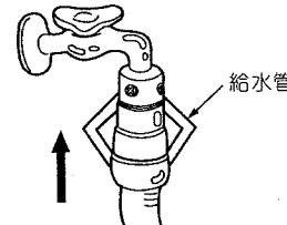
6 欲鬆脫時，將給水管上之滑動片向下壓，「ㄉ一ㄚ」一聲後，即可取下給水管，而將固定具留在水龍頭上。
