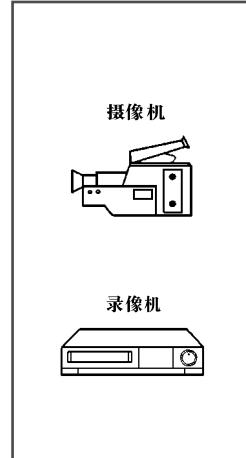
① 要播放画面和伴音，必须同时使用S-VIDEO和RCA (音频左+右) 两组连接线。
