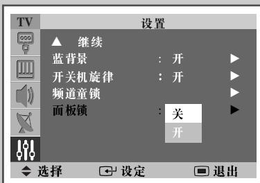
此功能可以让您锁定电视机，从而不能通过前面板按键控制机器。但您仍然可以通过遥控器打开锁定，这样使未授权用户无法变更机器设置。
