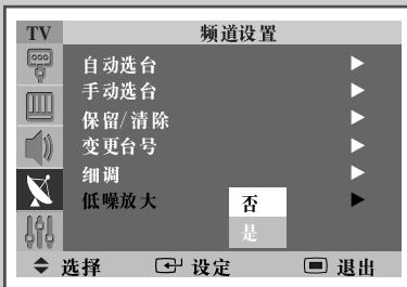
本功能在电视信号微弱的情况下非常有用。LNA 在信号微弱地区放大电视信号，抑制噪声信号。本功能只在弱信号条件下起作用，并记忆在当前频道。
