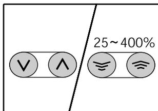
按下 [固定倍率] 选择键 (V, ^) 选择一个相近的倍率，然后使用 [变焦] 键 (≡, ≡) 以 1% 为增量调整倍率。显示器上显示倍率。
