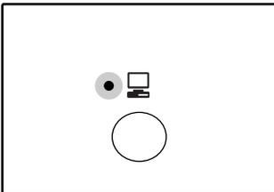
如果联机指示灯 ( ) 没有点亮，请按下 [ 联机 ] 键 ( )。指示灯没有点亮时机器是脱机的，此时不能进行打印。指示灯闪烁时，说明打印任务已经传送到机器了。
