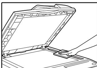
原稿台 / SPF 上的污迹和灰尘也会被复印下来，请使用柔软干净的布料擦拭原稿台、SPF 的原稿盖板部分和原稿台上的扫描窗口。
