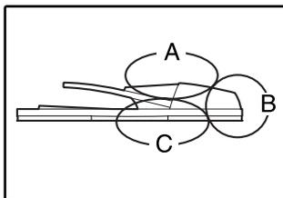
参阅下文的 A 节，B 节和 C 节中的图示（参见下页），清除卡住的原稿。
