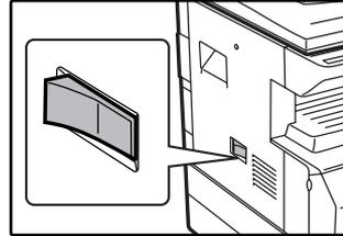
如果机器正在运作的时候关闭了电源开关，那么将会发生卡纸，正在处理的任务也会被取消。
