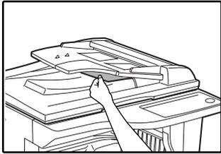
如果输出区域的纸张无法轻易清除时，请打开送稿托盘的可移动区域，然后清除卡纸。
