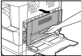
**2** 检查卡纸位置。按照下图所示获得清除卡纸的信息。
