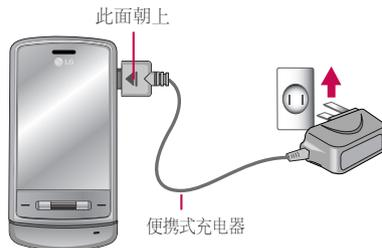
将便携式充电器直接连接到手机（充电插口上所带的塞子请勿拔掉）。
