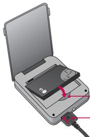
先将电池和座充的底部槽对正，再按下去直到听到“咔嚓”的声音。拔出时，按住电池的上端往外推。
