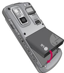
将电池两侧和手机侧槽对正后往下推，直到听见“咔嚓”的响声。
