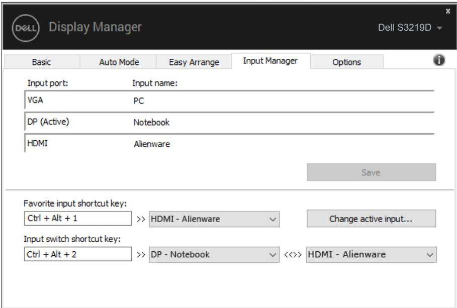
**NOTA:** DDM se comunica con el monitor incluso cuando este muestra vídeo de otro equipo. Puede instalar DDM en el equipo que utilice frecuentemente y controlar el cambio de entradas desde él. También puede instalar DDM en otros equipos conectados al monitor.
