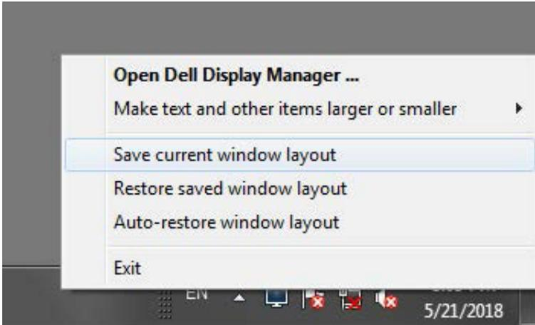
Puede utilizar monitores de distintos modelos o resoluciones en su rutina diaria, y aplicarles distintos diseños de ventanas. DDM es capaz de reconocer el monitor que haya vuelto a conectar y de restaurar las posiciones de la aplicación acorde a ello. Si necesita sustituir un monitor en la configuración matriz de un monitor, puede guardar el diseño de ventanas antes de sustituirlo y restaurar el diseño una vez se haya instalado el nuevo monitor.
