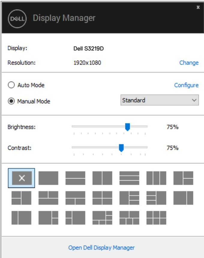
El cuadro de dialogo **Quick Settings (Configuración rápida)** también proporciona acceso a la interfaz de usuario avanzada de Dell Display Manager, que se utiliza para ajustar funciones básicas, configurar el modo automático y acceder a otras funciones.
