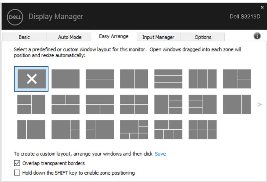
Para crear un diseño de ventanas personalizado, ajuste el tamaño y la posición las ventanas (10 ventanas, como máximo) en el escritorio y, a continuación, haga clic en el vínculo Guardar en **Easy Arrange (Ajustar fácilmente)**. El tamaño y la posición de las ventanas se guardan como un diseño personalizado y se crea un icono para dicho diseño.
