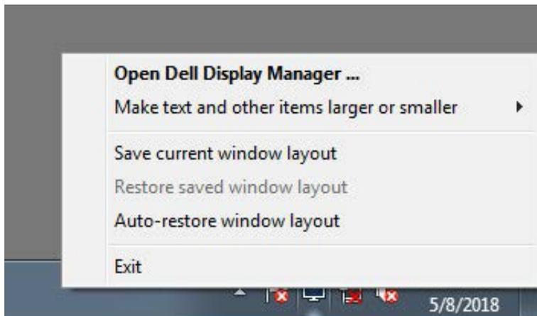
Si selecciona “**Auto-restore window layout (Restaurar automáticamente el diseño de la ventana)**”, DDM supervisará y recordará las posiciones de las ventanas de su aplicación. DDM coloca automáticamente las ventanas de la aplicación en sus posiciones originales al volver a conectar su ordenador al monitor.
