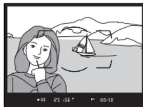
No cambie la distancia entre la cámara y el sujeto mientras el bloqueo de enfoque esté activado. Si el sujeto se mueve, vuelva a enfocar a partir de la nueva distancia.
