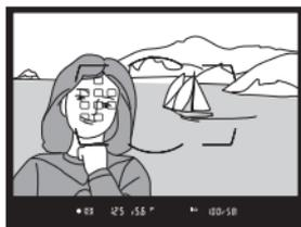
El modo de zona AF puede seleccionarse pulsando el botón de modo AF y girando el dial secundario hasta que el ajuste deseado sea visualizado en el visor y en el panel de control.
