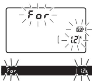
Vuelva a pulsar simultáneamente los botones para formatear la tarjeta (para salir sin formatear la tarjeta, pulse cualquier otro botón o espere aproximadamente seis segundos hasta que **F o r** deje de parpadear). Una vez finalizado el formateo, el panel de control y el visor mostrarán el número de fotografías que pueden realizarse con los ajustes actuales.
