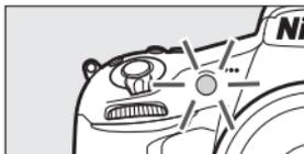
Dos segundos antes de tomar la fotografía, la luz del disparador automático dejará de parpadear. El obturador se abrirá aproximadamente 10 segundos después de iniciarse el temporizador.
