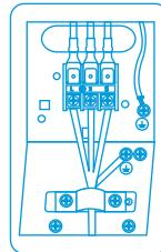
1. 电源线使用U型舌压接，防止脱落。
