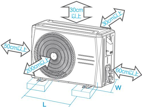
确保选配连接管和电缆线长度满足所选安装位置要求
