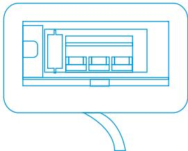
根据国家标准的强制要求，空调器最大电流 $\geq 16A$ ，应使用带保护装置的空气开关或漏电保护开关，具体详见说明书安全注意事项条款。
