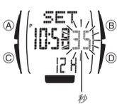
1. 在計時功能畫面顯示時，按住 **(A)** 鈕約兩秒鐘直到現在時間的秒數開始閃動。此表示現已進入設定畫面。
