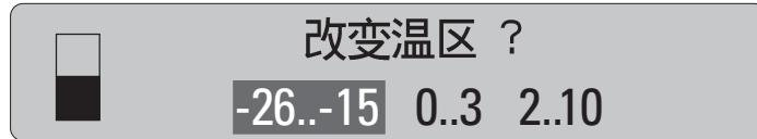
使用“>”键选择“0..3”，并触摸“确定”键确认选择，显示屏中将出现下图信息。
