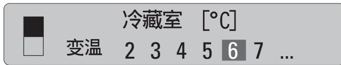
使用“&lt;”键选择“变温”，并触摸“确定”键确认选择，显示屏中将出现下图信息。
