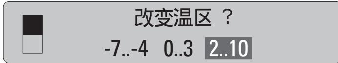
使用“<”键选择“-7..-4”，并触摸“确定”键确认选择，显示屏中将出现下图信息。
