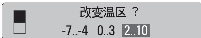
使用“&lt;”键选择“0..3”，并触摸“确定”键确认选择，显示屏中将出现下图信息。
