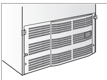
⚠ 不要覆盖或堵塞冰箱背部的压缩机挡板上的通风格栅。
