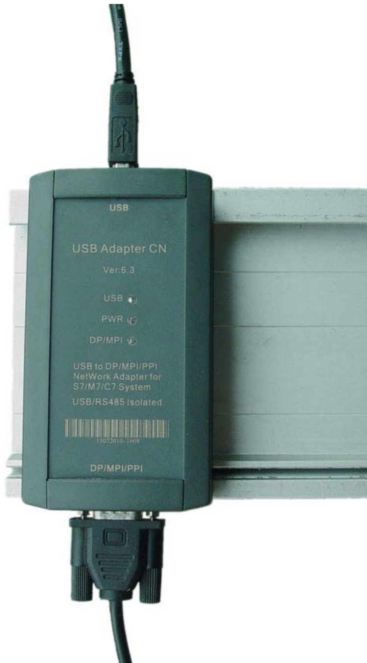
USB Adapter CN 适配器安装在 S7-300PLC 导轨上
