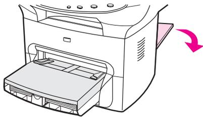
2. 在优先进纸盘中装入单页纸或在介质进纸盘中装入多页纸。确保介质的顶边在前且要打印的面（投影胶片的粗糙面）朝上。
