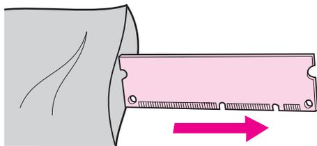
4. 将 DIMM 放在左侧面板内的插槽前面。金色触点应指向设备，凹口应在顶部和底部。
