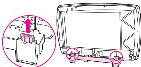
3. 将铰链竖直向下插入设备，安装新的 ADF。
