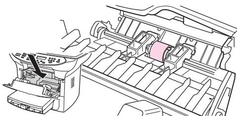
4. 松开拾纸轮两侧的白色小压片，向前旋转拾纸轮。
