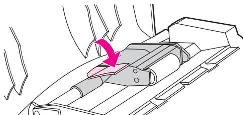
9. 如图所示插入清除部件，以重新安装。按下两个压片，直至部件卡入到位。请正确安装清除部件，因为如果未能正确重新装入清除部件，以后仍有可能发生卡塞。
