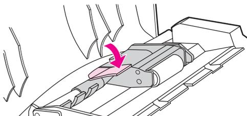
6. 要检查安装是否正确，请提起绿色手柄，直到其处于打开位置。新的拾纸轮组件应该固定到杆组件上并且不应落下。
