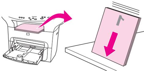
8. 将已打印第一面的页面再次放入进纸盘。第一面应朝下，底边应先送入设备。
