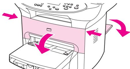
2. 向下旋转设备后面的绿色压放手柄。如果可以在不卸下打印碳粉盒的情况下从设备前部取出介质，则如此操作，然后继续执行步骤 4。
