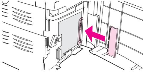
5. 小心地将 DIMM 按入插槽，确保平直且完全插入 (1)。顶部和底部的凸轮栓锁应向内转动。要使凸轮栓锁锁定到位，请朝相对方向按手柄 (2)。
