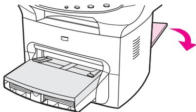
2. 装入介质时，应使其窄边在前且要打印的面朝上。调整两侧和后部的介质导轨，使其正好将介质固定住。
