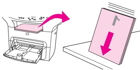
7. 将纸叠再放入进纸盘中。第一面应朝下，底边应先送入设备。重新装上优先进纸盘。
