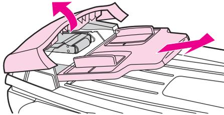
2. 卸下卡塞清除部件。用双手提起两个手柄，直到部件啮合部分松开。旋转并提起卡塞清除部件，然后将其放在一旁。
