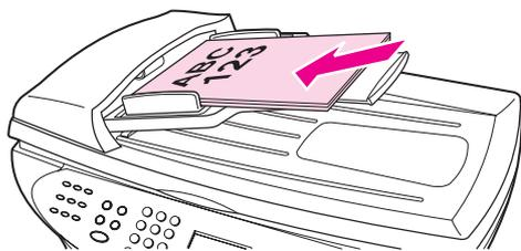
3. 将纸叠滑入 ADF 进纸盘，直到纸叠无法移动为止。
