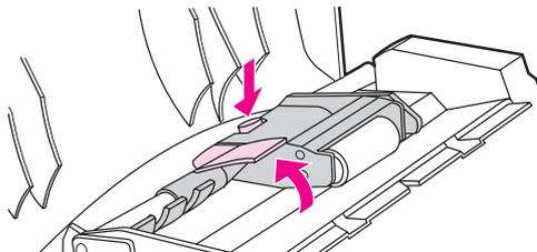
4. 卸下旧组件，然后将新组件放在与旧组件完全相同的位置上。最大的滚筒已安装到位，而齿轮端将位于远离您的位置。
