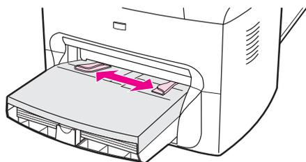
3. 如果信封有一个沿长边折叠的封盖，请将打印面朝上，有折叠封盖的一边放在左侧。如果信封有一个沿短边折叠的封盖，请先将该边送入设备，打印面朝上。
