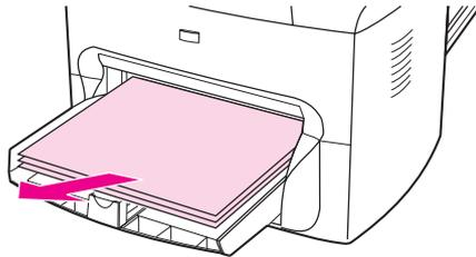
6. 收集打印好的页面，将打印面朝下并使纸叠齐整，然后将纸叠再次放入进纸盘。第一面应朝下，底边应先送入设备。
