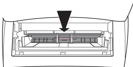
4. 要从用弹簧负载的底座上撬下分隔垫，请将平口螺丝刀插入分隔垫下的槽中，然后转动螺丝刀直到压片变松。
