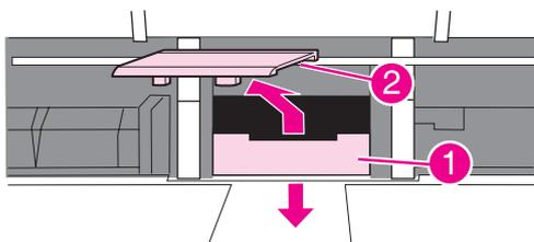
6. 一只手将新的分隔垫放入以前安放分隔垫 (1) 的槽中。另一只手伸入进纸盘的开口处，按下弹簧负载的底座 (2)。
