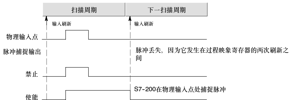
图4-25 带有和不带有脉冲捕捉功能的S7-200操作
