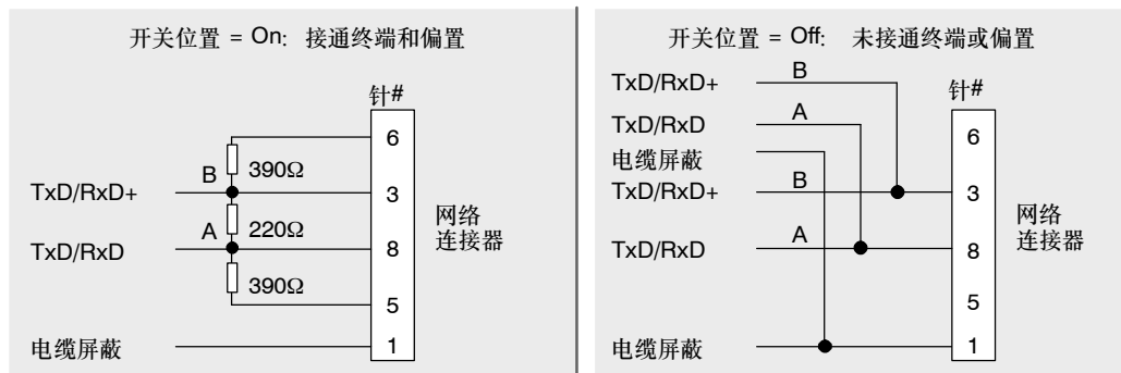
图11-5 网络电缆的偏置和终端
