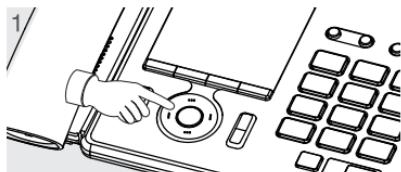
1. 座机在待机或摘机状态下，连续按
