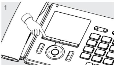
1. 在待机状态下，按住座机上的 注册键不放，待座机发出“嘀”一声长响且 开始闪烁时松开。
