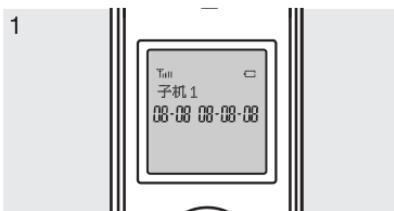
1. 子机的电池电压低于电容3%时，会响起低电量提示音，提醒您及时充电。当电池电量耗尽时，子机会自动关机。
