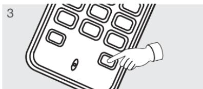
1. 座机在待机状态下，按目的子机号码键呼叫子机(若呼叫3号子机或4号子机，则按住 子机1键 或 子机2键 键3秒)。
