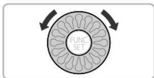
转动控制转盘可操作相机的功能，如选择项目或切换图像。此外，除一部分操作外，其他操作类似于使用▲、▼、◀、▶等按钮。
