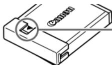
将盖子装到已充电的电池上，露出▲标志。
