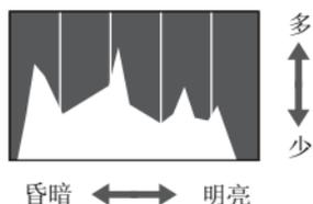
“详细信息显示”(第44页)中出现的图表称作柱状图。柱状图表示图像亮度的分布和数量。横轴代表亮度，纵轴代表每个亮度上的数量值。当柱状部分(即白色部分)集中靠右时，说明图像较亮；反之，集中靠左时，说明图像较暗。由此可查看图像曝光状况。
