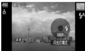
在拍摄模式下，如果将手指放在控制转盘上，则在屏幕上会出现提示，可确认按钮对应的功能。如果切换至播放模式，提示会在屏幕上显示数秒钟。
