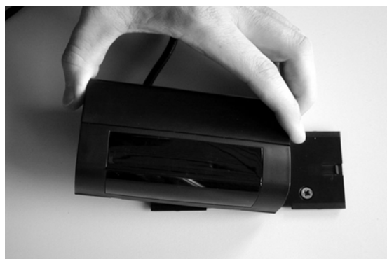
图 10: 将ESPROS 外壳从固定板上移出
