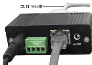
图 11 网络摄像机连接接线盒
