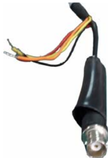
图 9 网络高速球连接线
