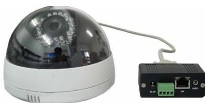
图 3 网络红外半球机连接图
