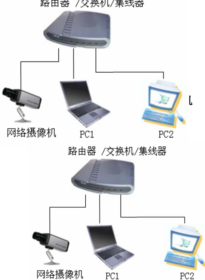
图10 网络摄像机通过共享器连接到网络
