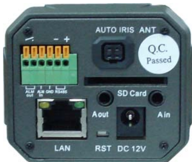
图 1 存储网络枪机后面板图
