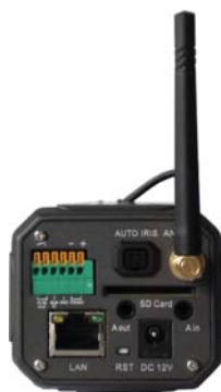
图 2 无线存储网络枪机后面板图
