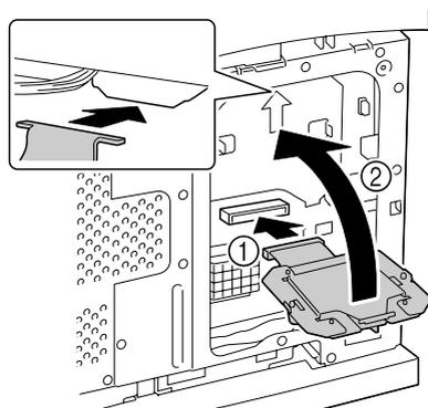
7 如图所示将 CF 适配器安装到控制器板上，然后固定螺钉。
