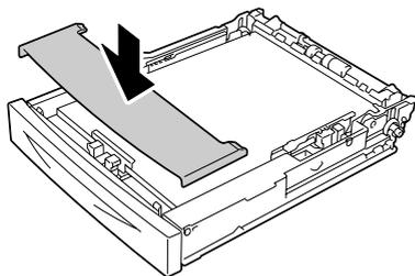
8 将纸盘完全推入打印机。
