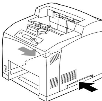
8 在他人的协助下，将打印机放置在下进纸部件的上面，并确保下进纸部件的定位销插入打印机底部的孔。
