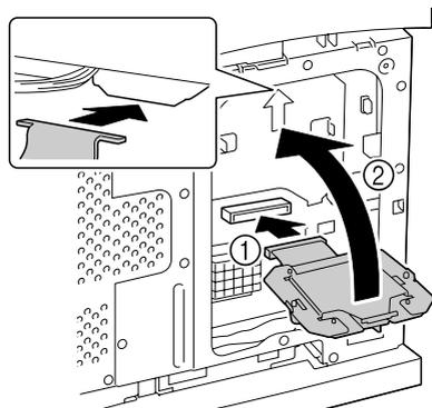
7 如图所示将硬盘套件安装到控制器板上，然后拧紧两颗螺钉。
