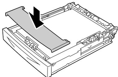
9 将纸盘完全推入打印机。
