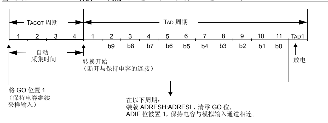
图 19-5: A/D 转换 TAD 周期 (ACQT<2:0> = 010, TACQ = 4 TAD)
