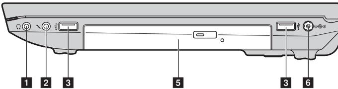
**1** 耳机插孔 连接外接耳机。
