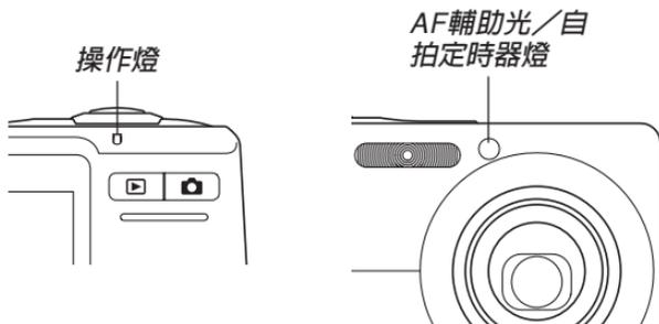
\* 指示燈的閃動樣式有三種。樣式1每秒鐘閃動一次，樣式2每秒鐘閃動兩次，而樣式3每秒鐘閃動四次。下表介紹各閃動樣式的含義。
