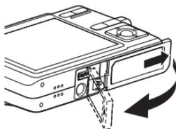
2. 裝入記憶卡時，以其背面與相機顯示幕朝向相同的方向將其小心地插入卡槽。記憶卡要插到底直到聽見喀嚓聲固定到位為止。
