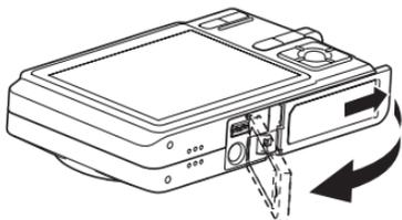
2. 在依插圖中箭頭所示方向撥開閉鎖器的同時，對齊電池上的箭頭標誌與相機上的箭頭標誌並將電池插入相機。
