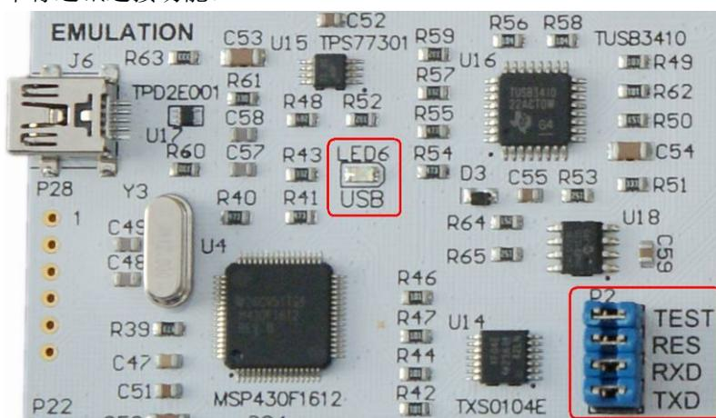
图 1.2.10 板载仿真器模块外观图
