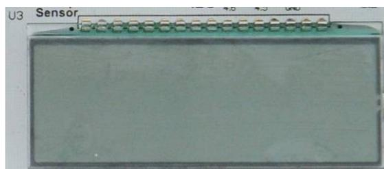
图 1.2.28 段式液晶外观图
