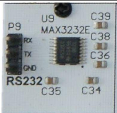
图 1.2.13 RS232 串口模块外观图
