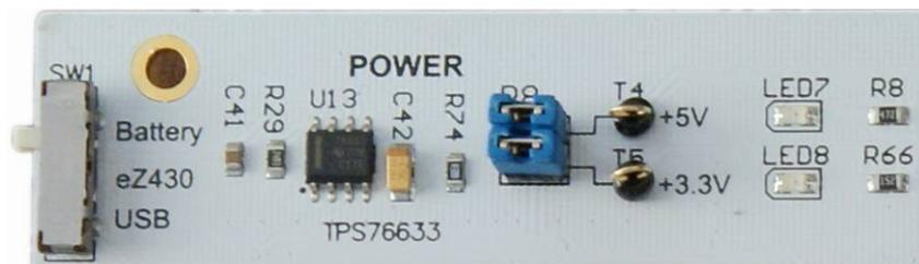
图 1.2.2 电源模块外观图
