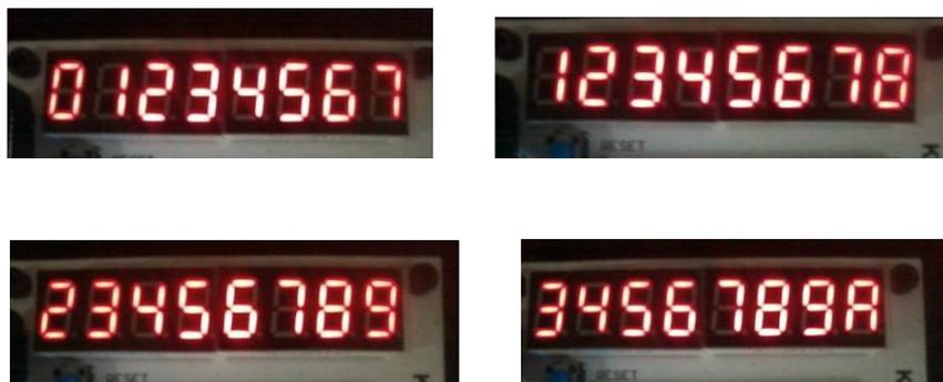
图 3.8.7 数码管字符循环显示
