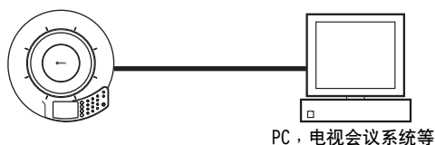
使用音频线连接到外部装置
