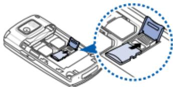
4. 合上金属盖，并沿着 LOCK 指示方向推动金属盖，直到存储卡锁定到位为止。
