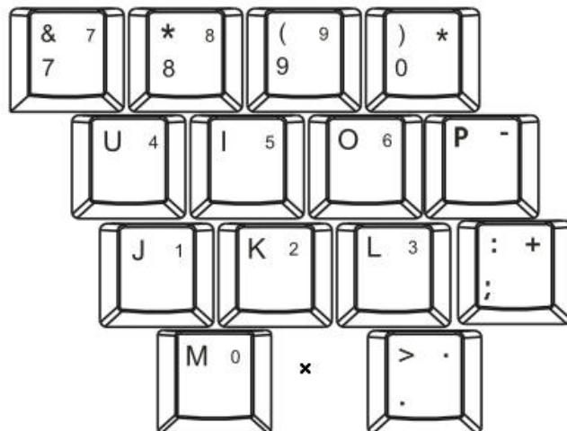
数字键方便您输入数字或做计算用。按下 **Fn+NumLk** 键后，屏幕右下脚显示 图标，表示数字键已锁定，您便可使用数字键。
