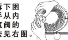
③ 按箭头所示有“松”字的方向旋转，向前拉，即可将组件分开。
