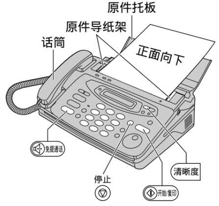
**1** 打开原纸托板，调整原纸导纸架，使其与原纸宽度相符
