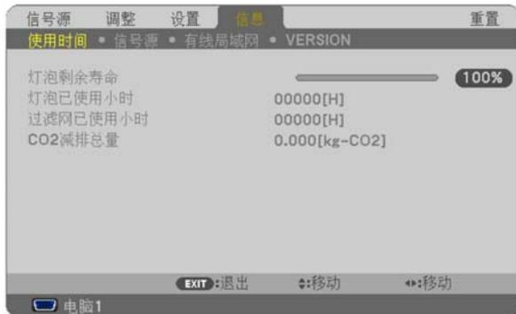
[CO<sub>2</sub> 減排量]表示從開機後即切換為節能模式到關機時止的 CO<sub>2</sub> 減排量。[CO<sub>2</sub> 減排量]將在關機時出現的[關機/確定?]資訊中顯示。
