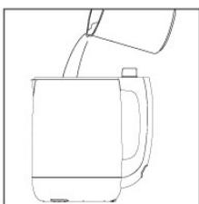
请按食谱中相应比例加冰水和牛奶至上、下水位刻度线之间。(本机具有无水防干烧功能,如杯体内无水或水位过低,机器不会工作,以保证使用安全。)
