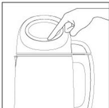
请将机头按正确的位置放入杯体中,插上电源线,指示灯全亮,左右触摸“选择”键选择果酱,这时果酱功能对应图形指示灯亮,再触摸“启动/取消”键启动果酱功能程序。
