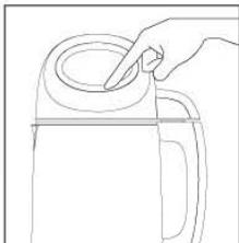
请将机头按正确的位置放入杯体中，插上电源线，指示灯全亮，左右触摸“选择”键选择相应功能，这时被选择功能对应图形指示灯亮，再触摸“启动/取消”键启动相应功能程序。
