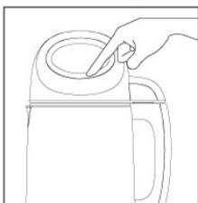
请将机头按正确的位置放入杯体中,插上电源线,指示灯全亮,左右触摸“选择”键选择果汁,这时果汁功能对应图形指示灯亮,再触摸“启动/取消”键启动果汁功能程序。
