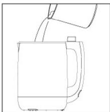
请按食谱要求加入纯净水。(本机具有无水防干烧功能,如杯体内无水或水位过低,机器不会工作,以保证使用安全。)
