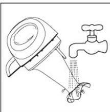
2. 超微精磨器：请用清洗刷仔细清洗超微精磨器，一定要用清水冲洗干净，以免残留豆浆产生异味。
